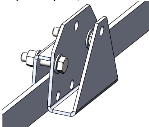
2. К первому ряду опор крепятся стойки ограждения 1 и соединяются со вторым рядом опор стяжками 2.
