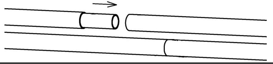
5. При соединении между собой соседних секций снегозадержателя обжатые концы одной трубы вставляются в свободные концы другой, и фиксируются болтами.
